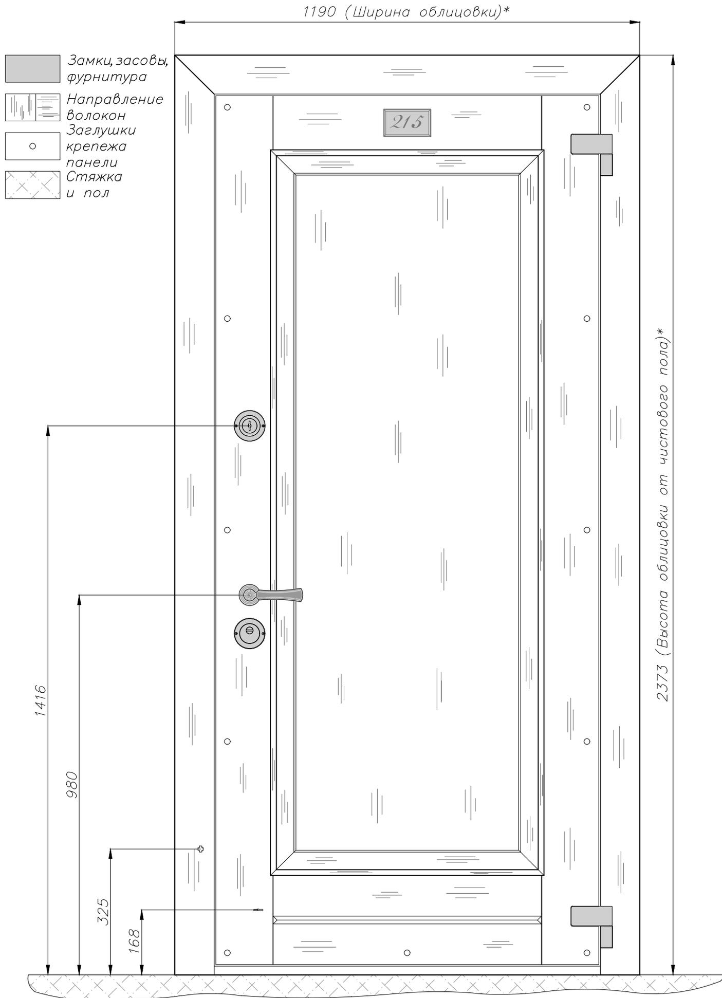
\* Облицовка согласовывается/оплачивается отдельно. Показан наличник 100 мм
